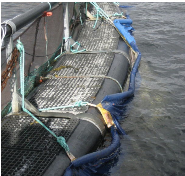
Figur 8 Ujevn innfesting av skjørtet skaper folder og lommer i skjørtet.
